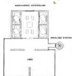
TROISIEME ETAGE au-dessus du toit-terrasse. Machinerie des ascenseurs et terrasse couverte.
