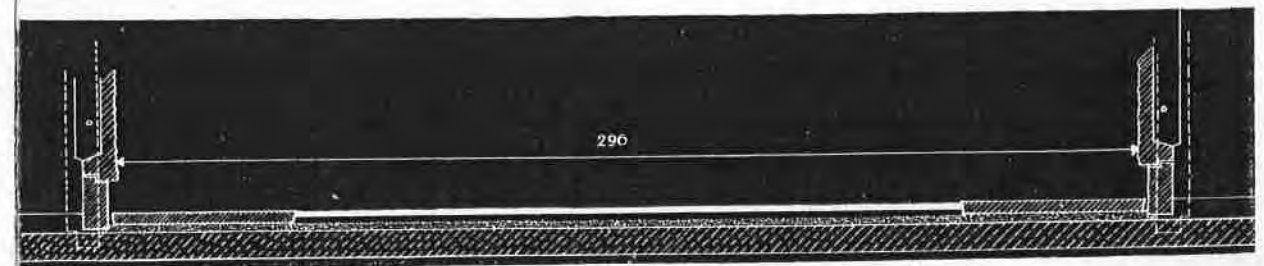
COUPE TRANSVERSE, LE SOL D'UNE RUE INTÉRIEURE. Au centre, caoutchouc ou linoléum; que côté, bandes de ciment.
